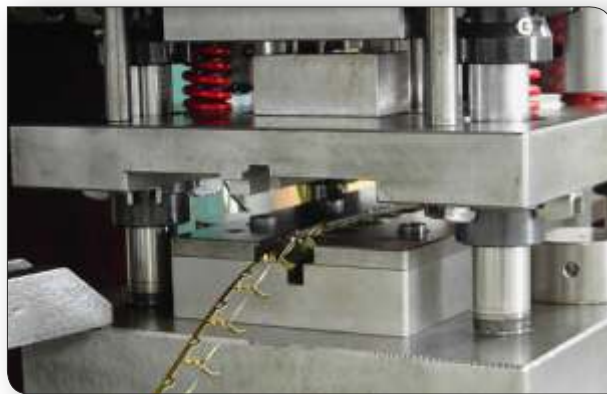
Estampación de pieza metálica estándar y bajo plano
